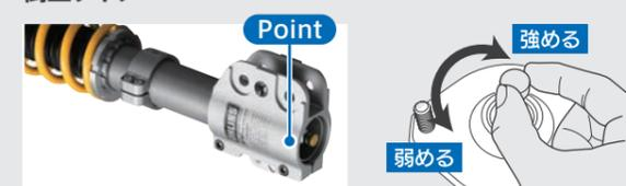
倒立タイプの多くは、ブラケット下部に調整ダイヤルが設置されています。
